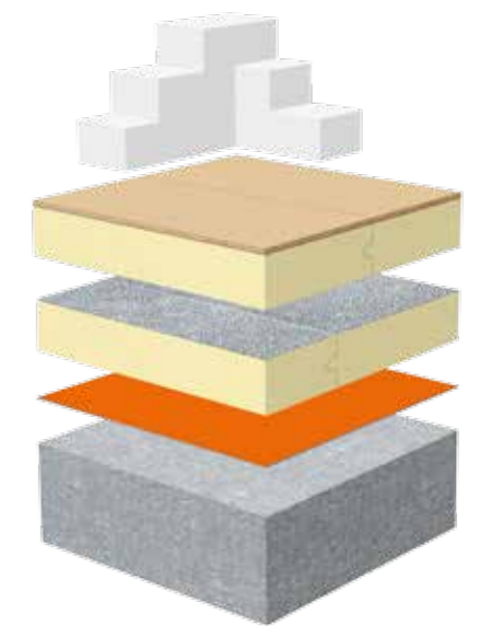
Dämmung des Kellerbodens mit BauderPIR DAL und BauderPIR DHW für höchste Anforderungen an den Wärmeschutz (Vorgaben KfW etc.)
