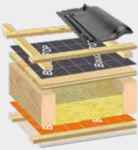
Verklebte Unterdeckung auf Holzschalung
