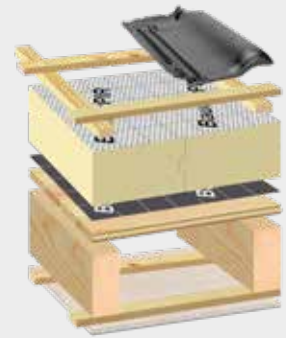
Luftdichte Schicht auf neuer Holzschalung unter neuer Aufsparrendämmung
